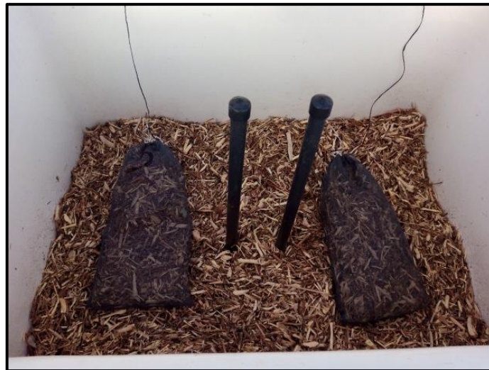
Figura 25. Sacos de malla mosquitera con astillas de madera para control futuro de la degradación de la madera
