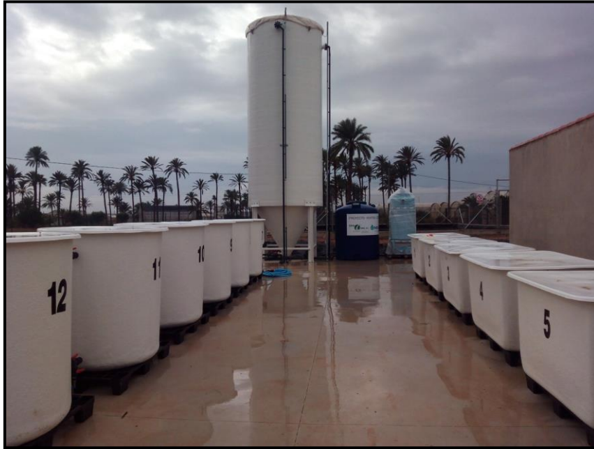
Figura 7. Imagen de los doce biorreactores ya instalados para la desnitrificación de las salmueras
